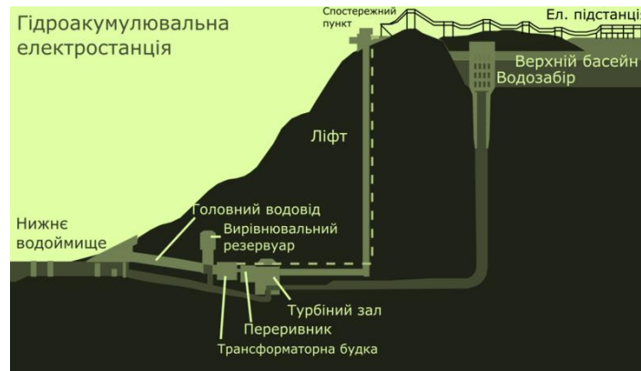
Рисунок 1 – Схема гідроакumuлюючої електростанції [3]
