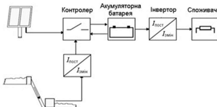
Рисунок 1 - Структурна схема типової гібридної енергетичної системи на основі використання джерел сонячної та гідро енергій.
