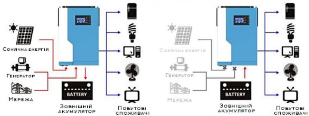
Рисунок 1 – Схема підключення гібридного сонячного інвертора.
