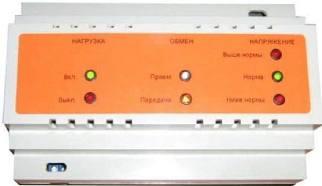
Автоматизована система комерційного обліку енергоресурсів АСКОЕ-ПОБУТ з вимірюванням показників якості
