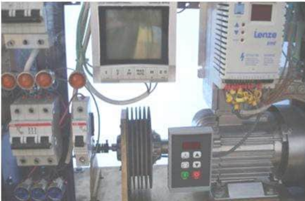
Стенд для дослідження асинхронного частотно-регульованого електропривоу
