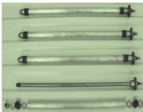
Агрегати для розколювання монолітних об'єктів гідророзривом (розривне зусилля 2500 кН, маса 4,5 кг). Патент України № 39144
