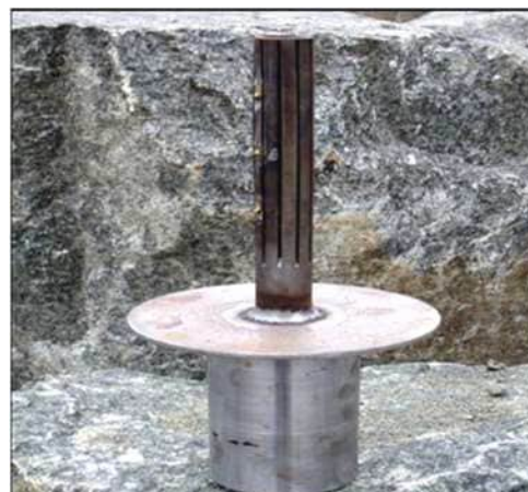
Гідродинамічна установка для блочного відділення каменю
