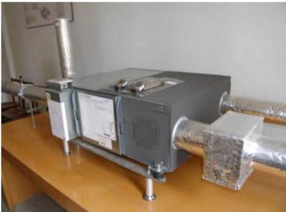
Lossnay LGH 15-RX4 - установка утилізації теплоти витяжного повітря для попередньої обробки припливного повітря
