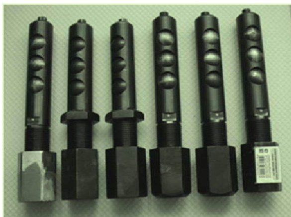
Портативні гідропоршневі агрегати (розривне зусилля 3000 кН, маса 2,8 кг)
