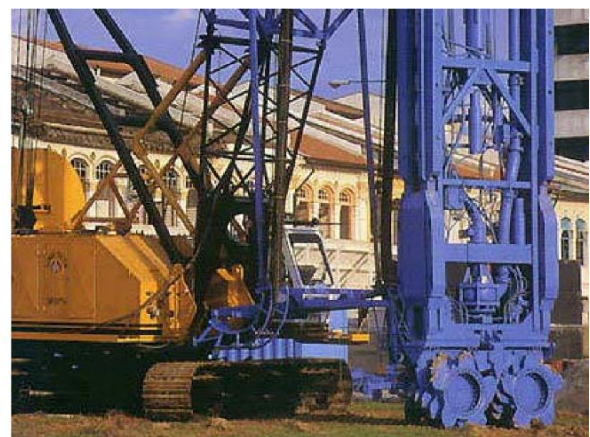
а) б) Рисунок 6 – Навісне обладнання для утворення «стіни в ґрунті»
