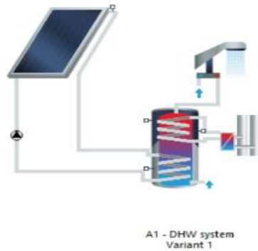
Рисунок 3– Схема функціонування системи сонячних колекторів
