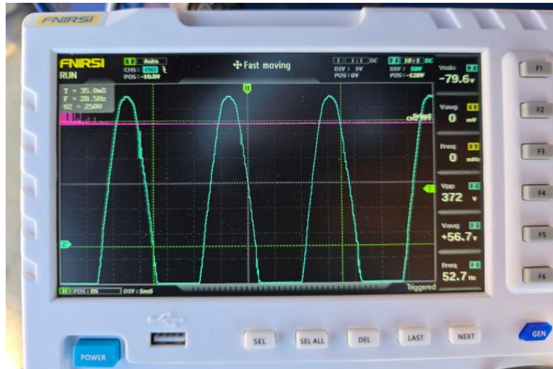
Рисунок 2. Форма сигналу плати AVR при 0 % навантаження
