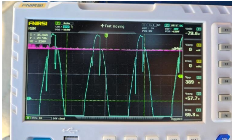
Рисунок 6. Форма сигналу плати AVR при 100 % навантаження
