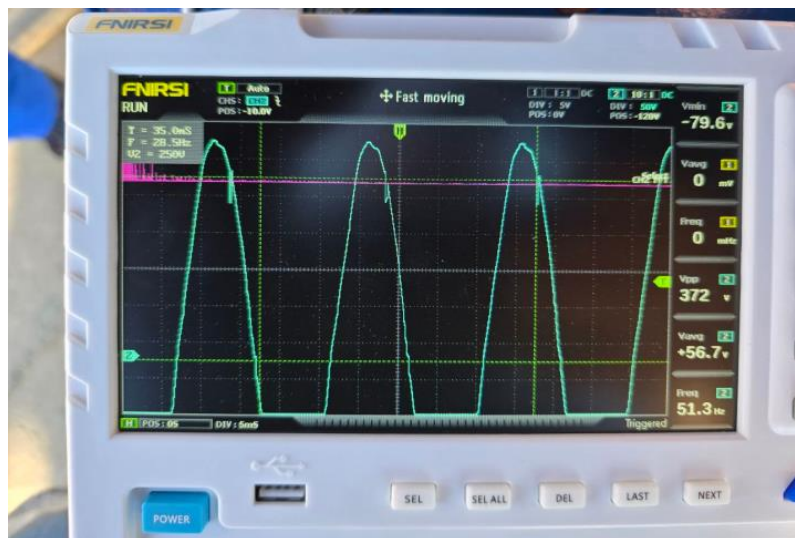
Рисунок 4. Форма сигналу плати AVR при 50 % навантаження
