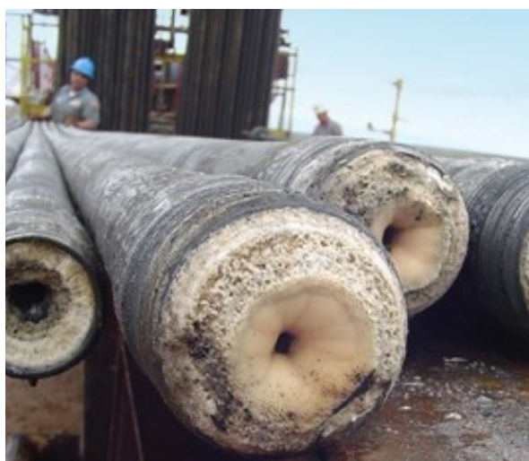
Рисунок 3 – Парафінові відкладення в насосно-компресорних трубах
