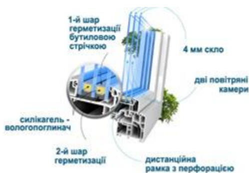
Рисунок 4 – Схематичне зображення склопакету
