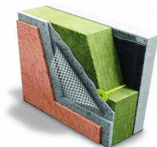
Рисунок 3 – Технологія утеплення стін
