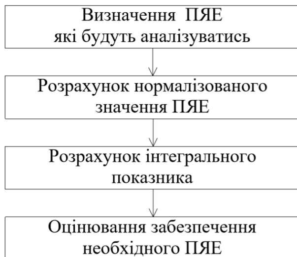
Рисунок 1 - Алгоритм розрахунку оцінювання якості електричної енергії
