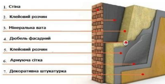
Рисунок 2 – Технологія виконання утеплення стін
