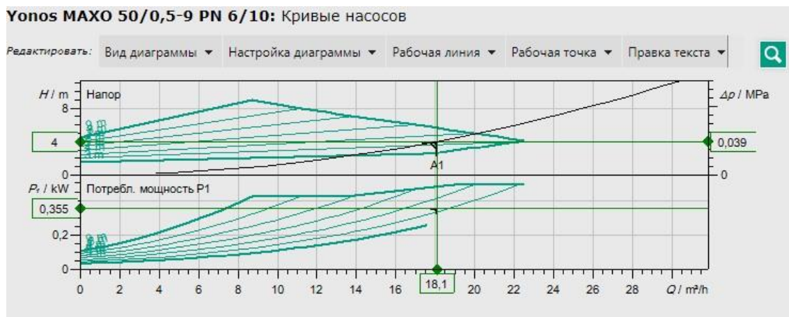
Рисунок 1 – Номограма насоса Yonos Махо 50/0.5-9 (робоча точка А1 знаходиться в 2/3 кривій)
